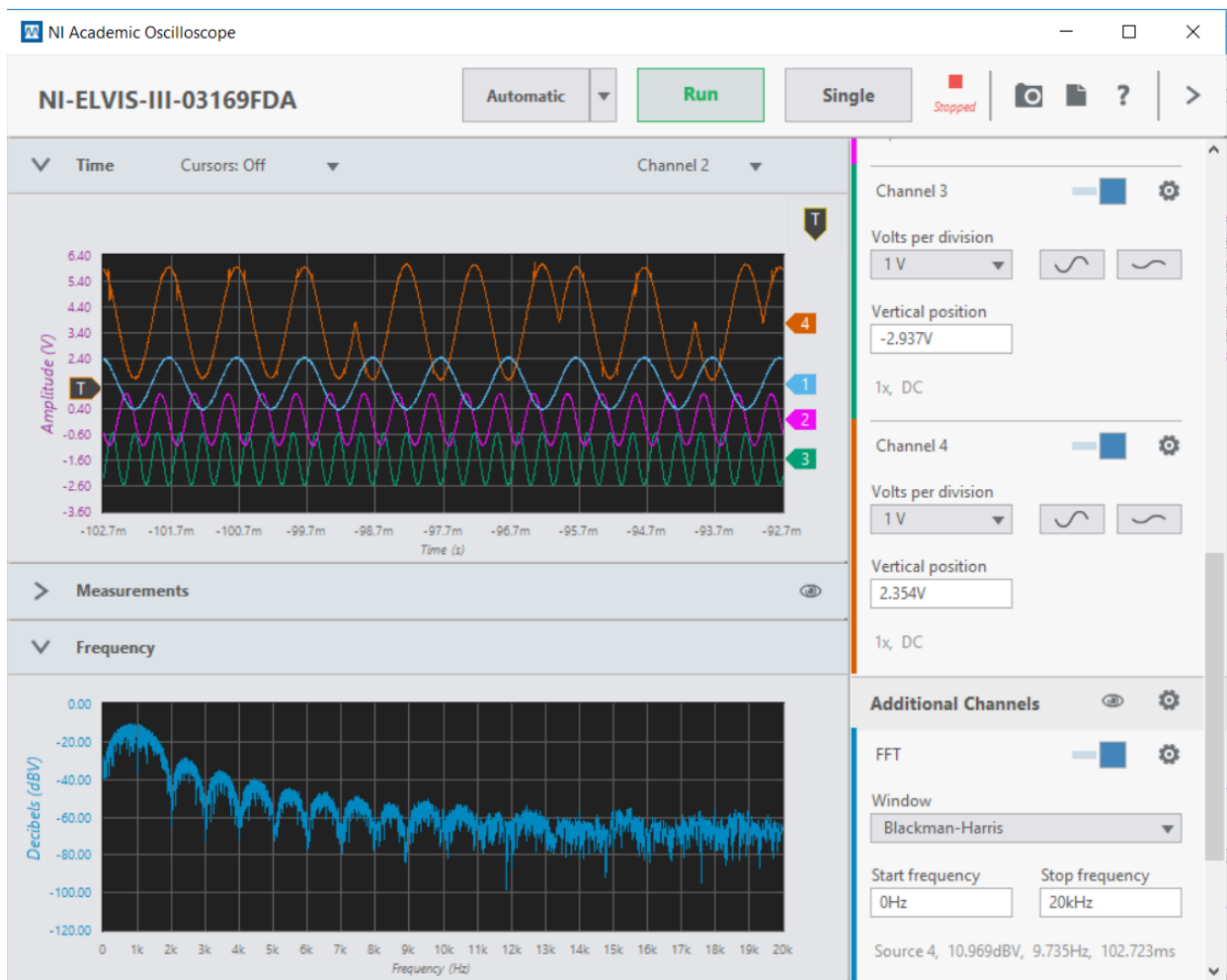
Рисунок 10: Осциллограммы и DFT поднесущих и BPSK сигнала для поднесущей SC1
